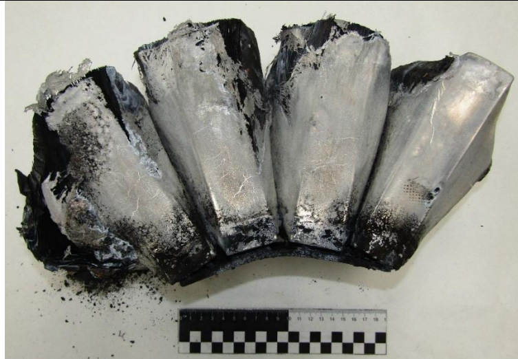
Рисунок 6 - Повреждения корпуса литий-ионного аккумулятора при внешнем тепловом воздействии
