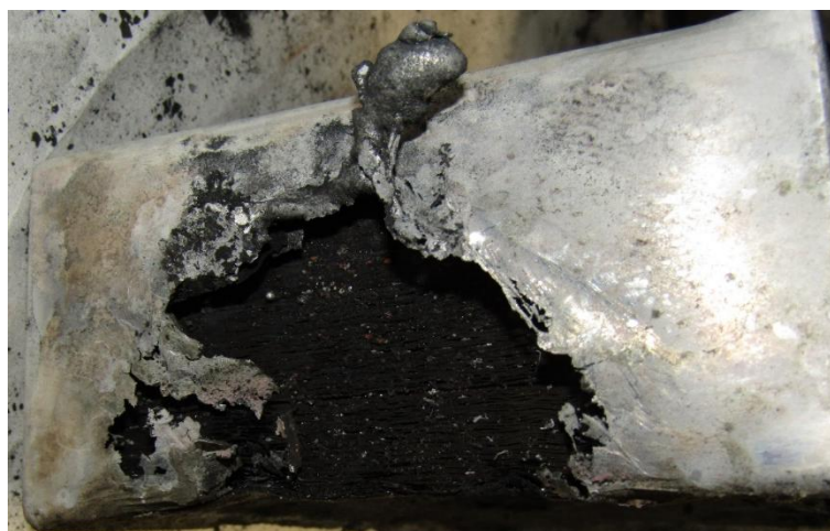
Рисунок 7 - Локальное оплавление поверхности корпуса литий-ионного аккумулятора при внешнем тепловом воздействии
