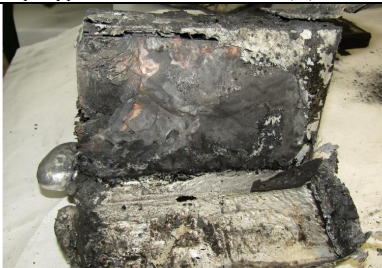
Рисунок 2 - Взрывной разрыв корпуса ЛИА
