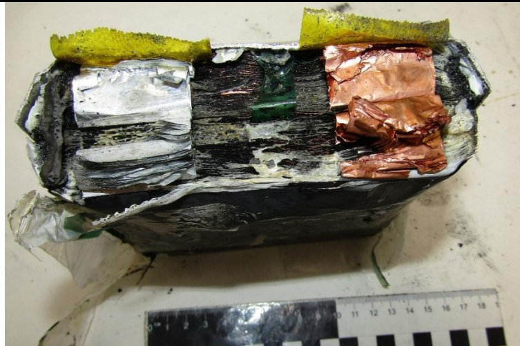
Рисунок 9 - Повреждения корпуса литий-ионного аккумулятора при механическом воздействии
