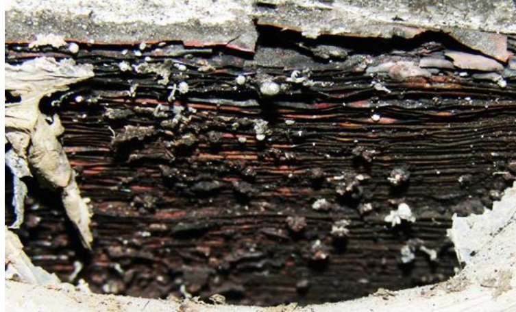
Рисунок 8 - Повреждения корпуса литий-ионного аккумулятора при внешнем тепловом воздействии
