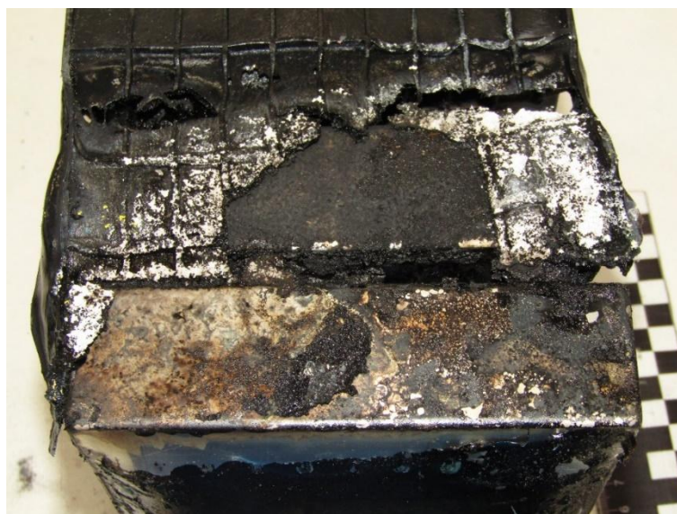
Рисунок 1 - Локальный разрыв корпуса ЛИА
