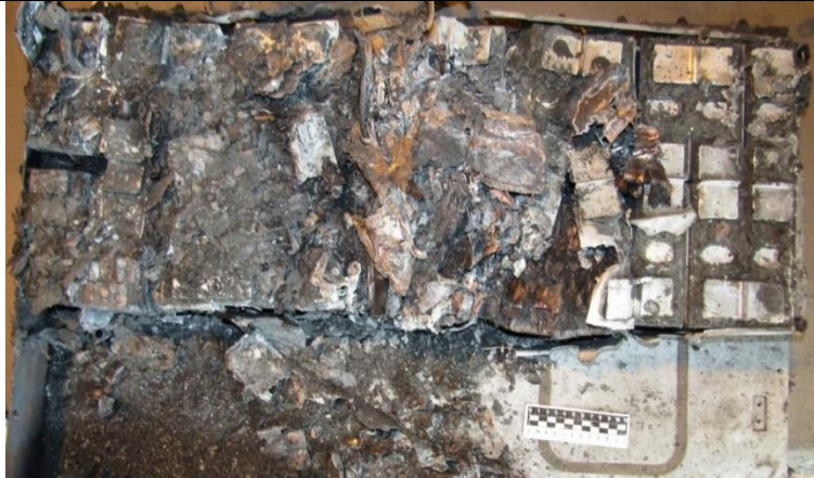
Рисунок 4 - Сохранность геометрии корпуса на участках, не затронутых прямым разрывом
