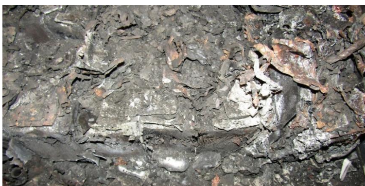
Рисунок 3– Фрагменты внутренних компонентов ЛИА, после теплового разгона вызванного перезарядом
