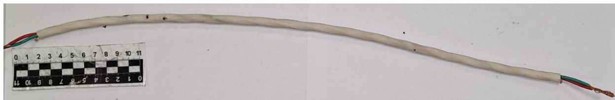
Рисунок 1 – Морфология повреждения кабеля СПОВ 3×1 после воздействия тока 40 А
