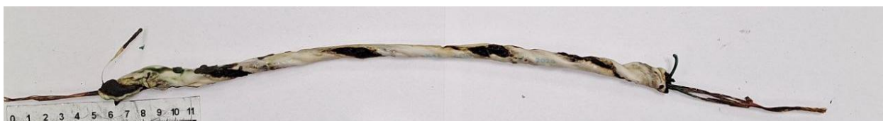
Рисунок 4 –Морфология повреждения кабеля СПОВ 3×1 после воздействия тока 240 А
