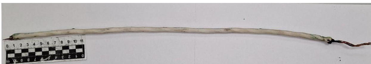
Рисунок 7 –Морфология повреждения кабеля СПОВ 3×1 после воздействия тока 480 А
