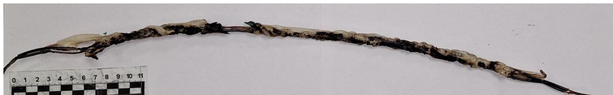
Рисунок 2 – Морфология повреждения кабеля СПОВ 3×1 после воздействия тока 120 А
