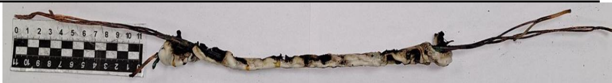
Рисунок 3 –Морфология повреждения кабеля СПОВ 3×1 после воздействия тока 180А
