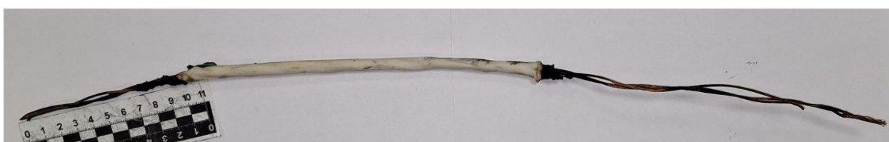
Рисунок 5 –Морфология повреждения кабеля СПОВ 3×1 после воздействия тока 300 А
