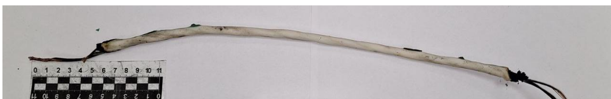
Рисунок 6 –Морфология повреждения кабеля СПОВ 3×1 после воздействия тока 390 А
